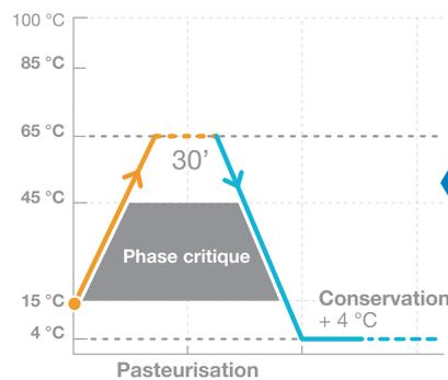
Avec le système automatique de **autopasteurisation** on peut choisir quand nettoyer la machine jusqu'à un intervalle maximum de 42 jours. Comme garantie supplémentaire de sécurité hygiénique, si l'opérateur n'effectue pas le nettoyage intégral à la fin des jours définis, la machine se bloque automatiquement.
